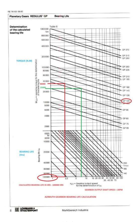
Figure 2- Azimuth Gear Box Bearing Life (Hrs)
