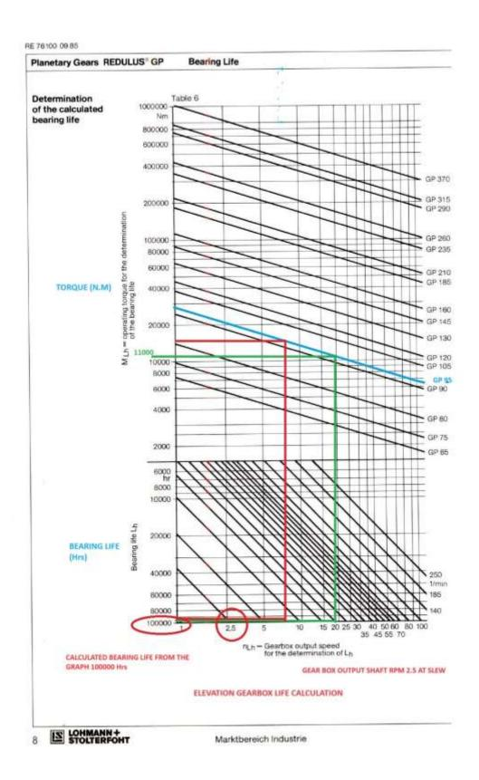
Figure 1- ELEVATION Gear Box Bearing Life (Hrs)
