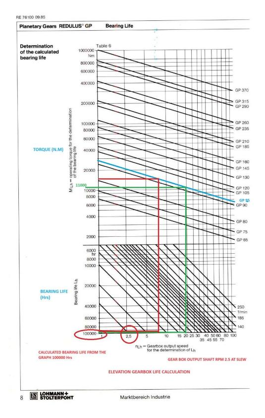
Figure 1- ELEVATION Gear Box Bearing Life (Hrs)
